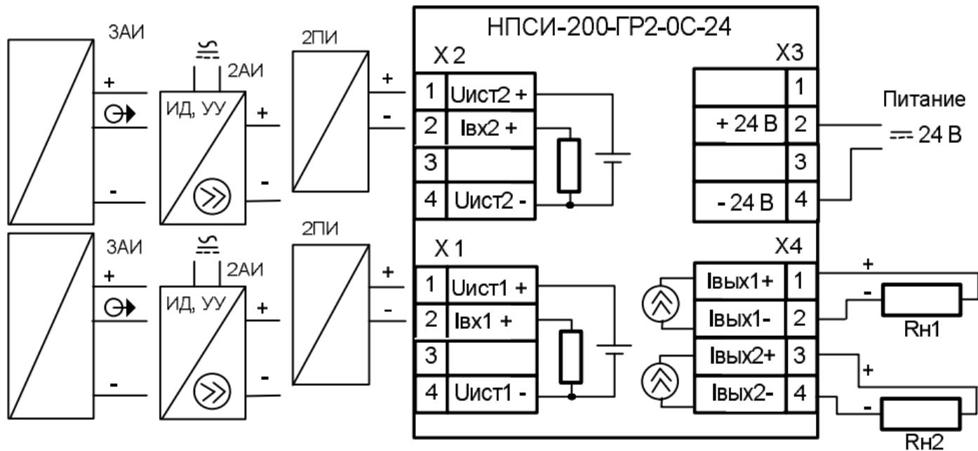
Рисунок 5.3 – Типовое подключение преобразователей НПСИ-200-ГР2-0С-24
