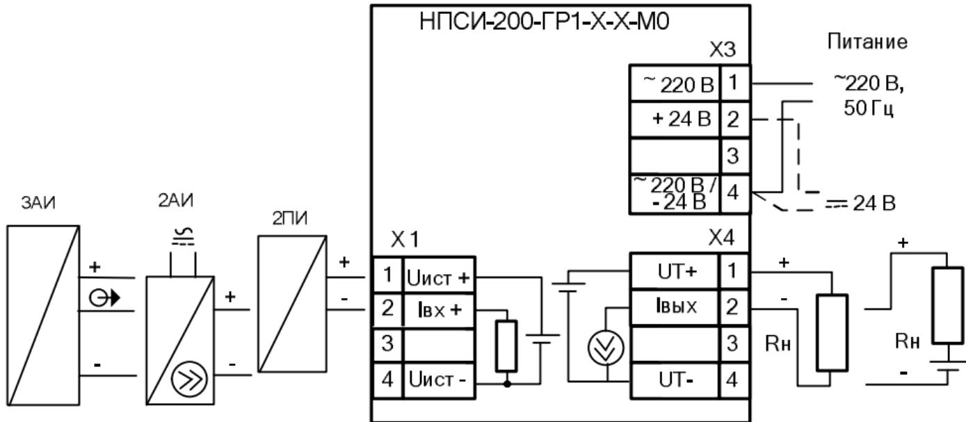
Рисунок 5.2 – Типовое подключение преобразователей НПСИ-200-ГР1
