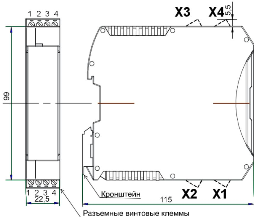
Рисунок 5.1 – Габаритные размеры НПСИ-200-ГРХ
